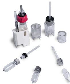
Dilatomètres de différentes tailles pour la mesure de matériaux poreux
