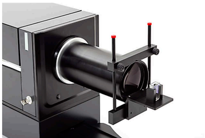
Мокрое измерение с использованием пакетной ячейки
