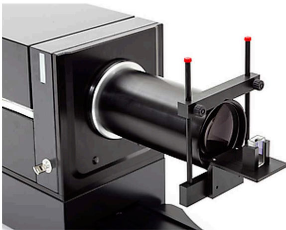
Natte meting met behulp van een meetcel
