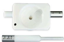
1 ml és 3 ml mérőcella dugattyúval
