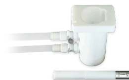
0 - 90 °C között temperálható mérőcella
